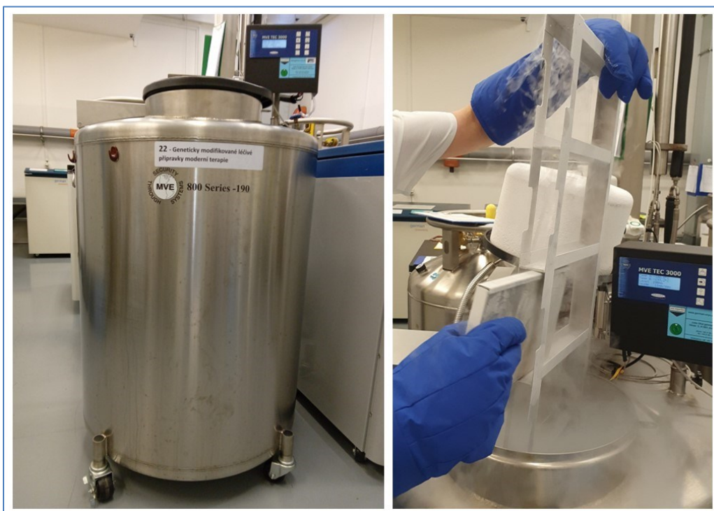
Obr. č. 31: Kryokontejner určený pro skladování propuštěných registrovaných nebo hodnocených geneticky modifikovaných LPMT MVE 815P-190-F (Chart Industries, Inc., USA), vpravo detail rámu vnitřní vestavy.
