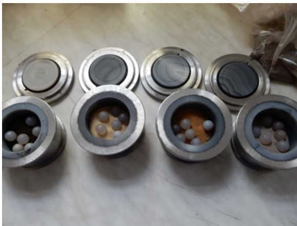
Fot. 3: Příprava misek s přesetými vzorky a achátovými kuličkami pro mletí v planetárním mlýnu
