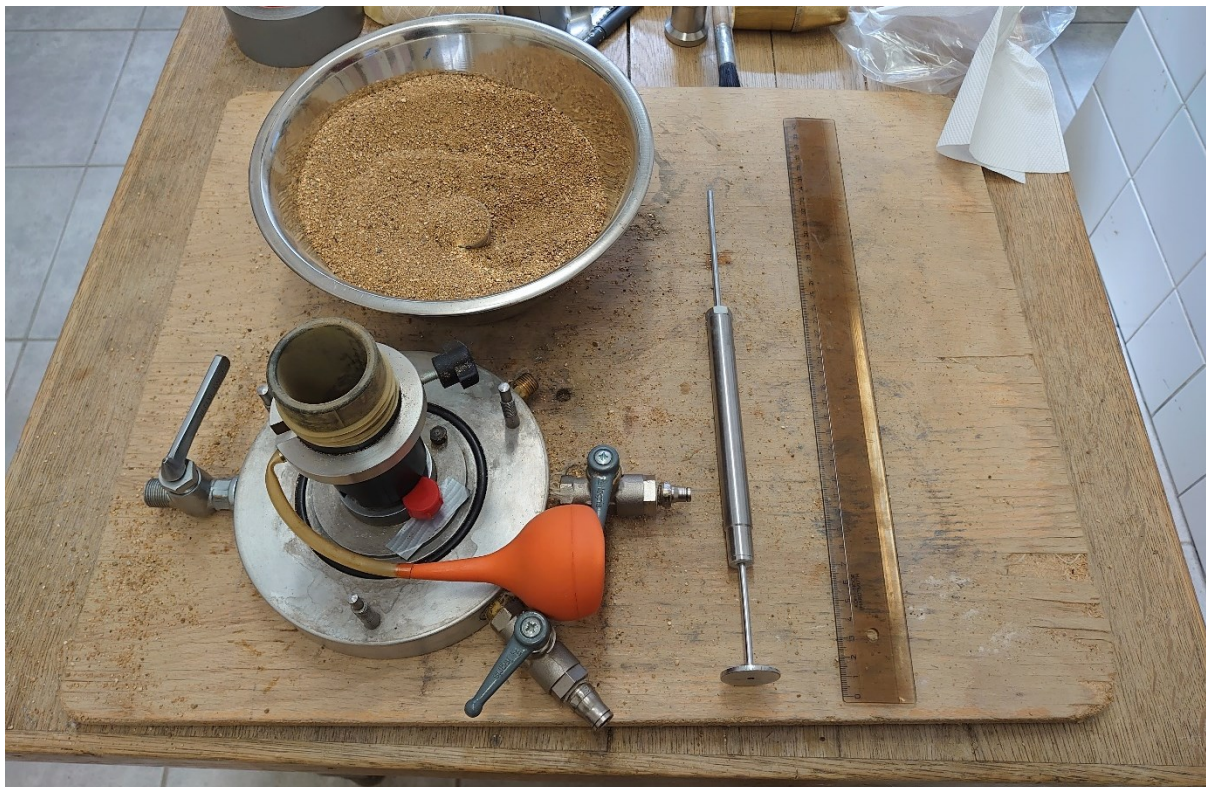
Obr. 47: Buchar a vakuová forma využívaná pro přípravu vzorku.
