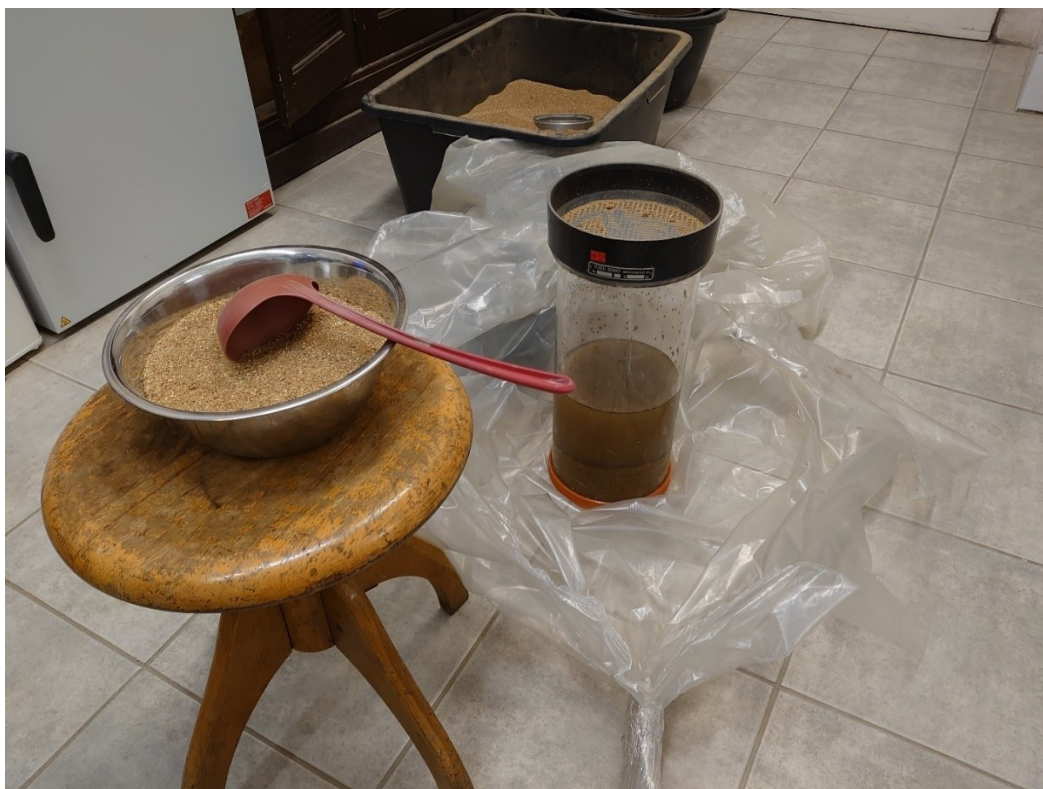
Obr. 38: Metoda měření e_{max} mokrou cestou.
