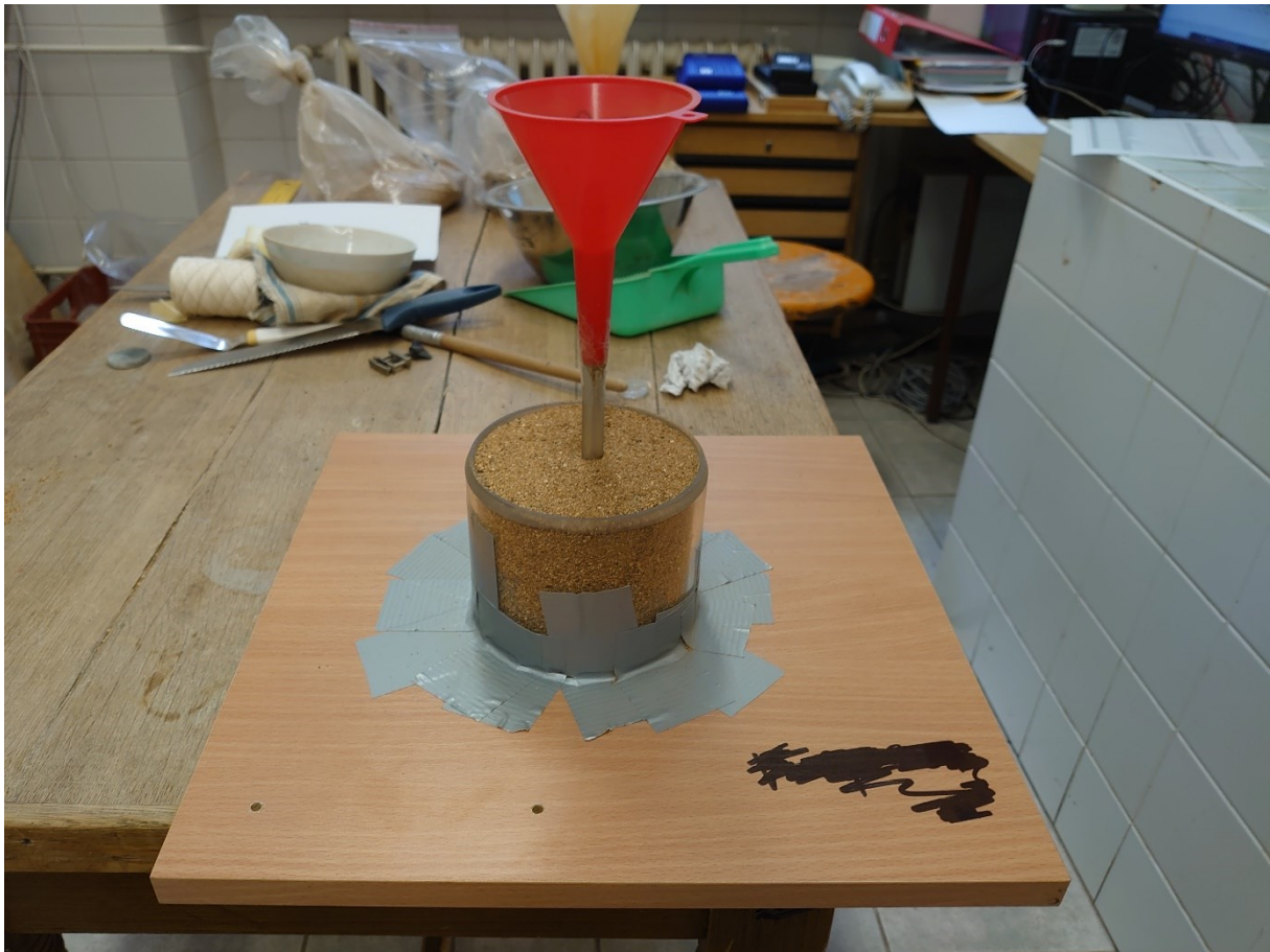
Obr. 37: Metoda měření e_{\max} suchou metodou.
