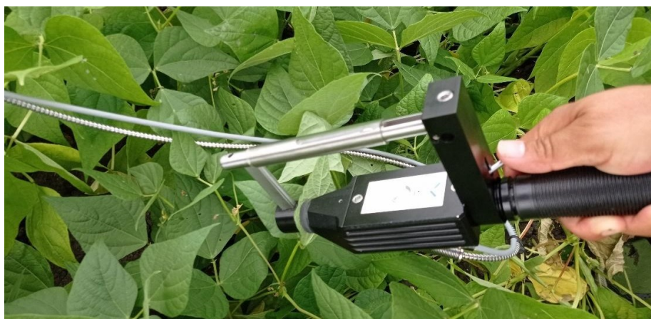
Obrázek 5 – Kontaktní měření odrazivosti listu v experimentálním poli pomocí spektrometru ASD FieldSpec® 4 Standard-Res s připojenou kontaktní sondou a svorkou na list. Foto: L. Svitáková.
