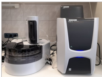
Obrázek č. 22: TOC-L CSH analyzátor Ústavu pro hydrodynamiku AV ČR, v. v. i. (vlastní fotodokumentace, 2021)
