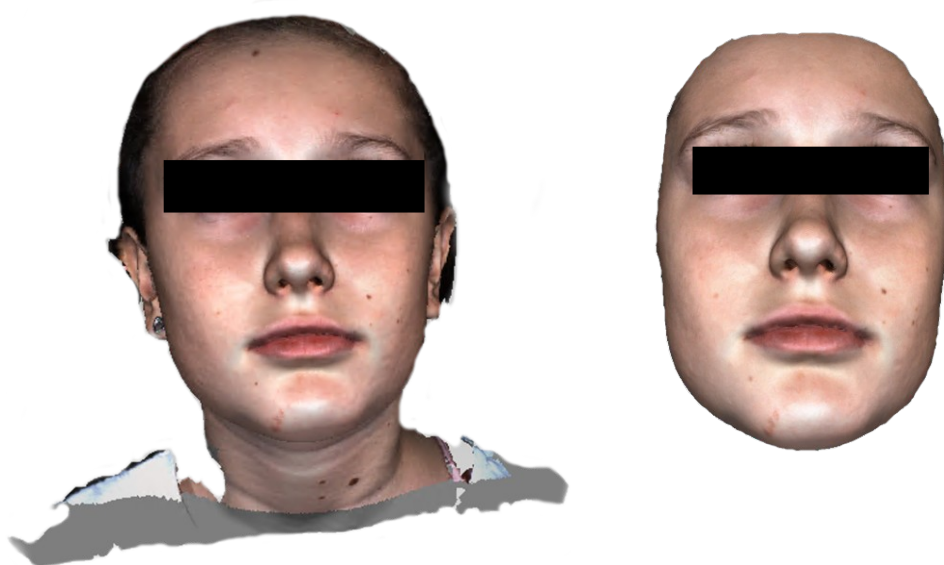
Obr. 5. Neorezaný 3D model tváre (vľavo), orezaný a zdecimovaný 3D model tváre (vpravo) v programe Rapidform
