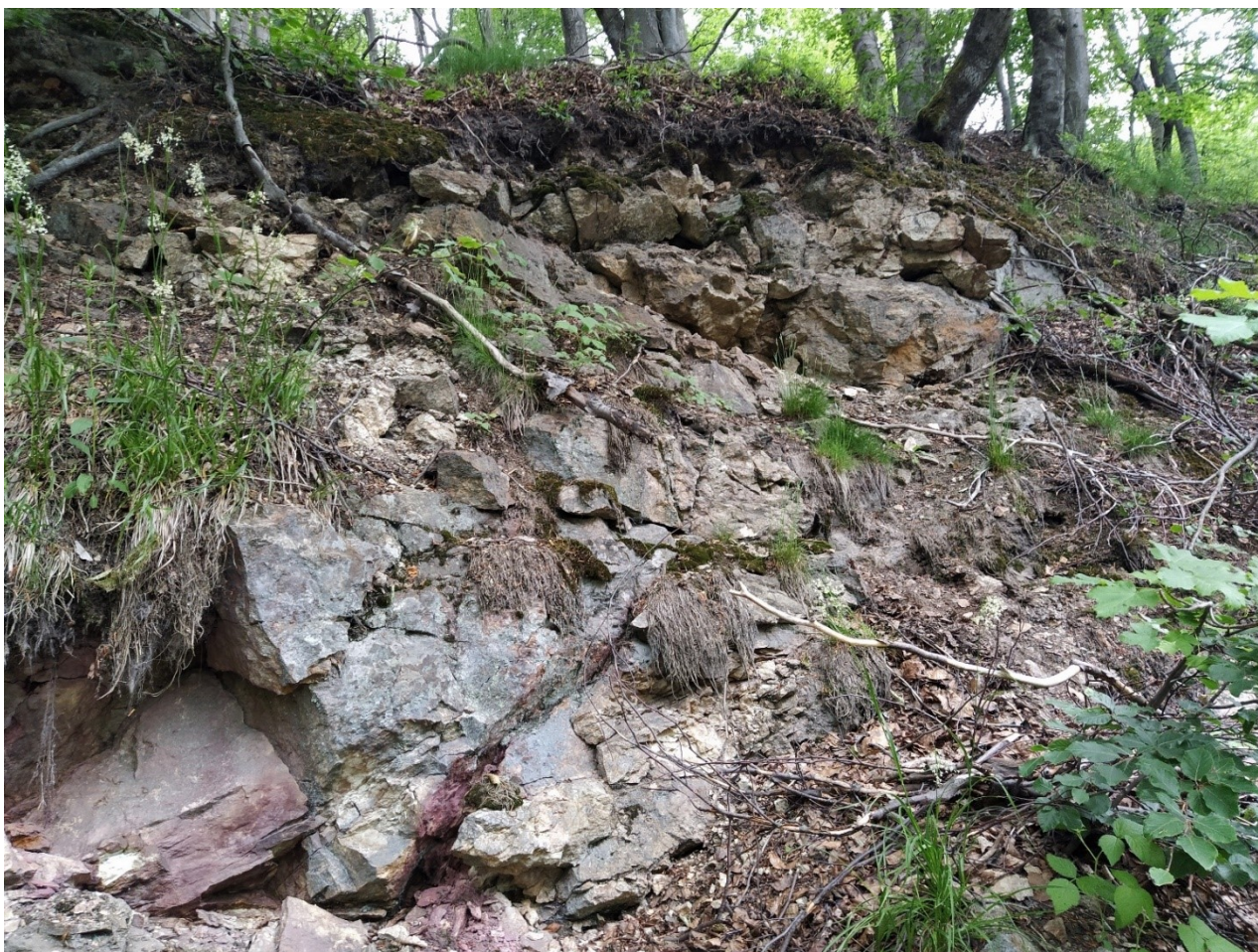
Obr. DB8: Pohled na mírně zvětralé ortoruly s červeno fialovým zabarvením druhotné výplně puklin (vlevo dole)
