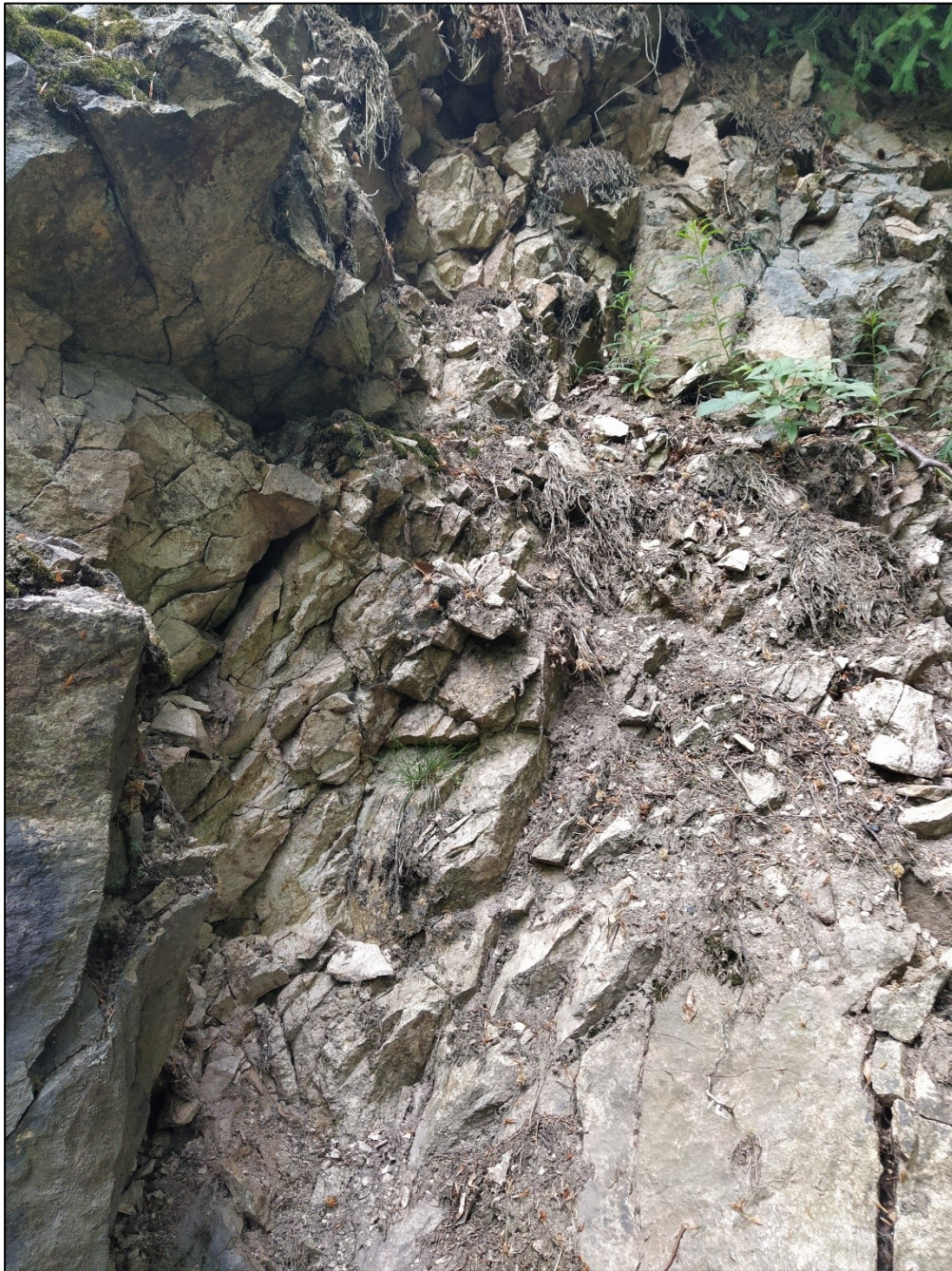
Obr. DB4: Pohled na tektonicky oslabenou polohu s velmi velkou hustotou diskontinuit výchozu DB4
