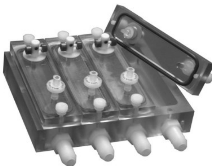
Obrázek 5 - The drip flow biofilm reactor (Azeredo et al. 2017)
