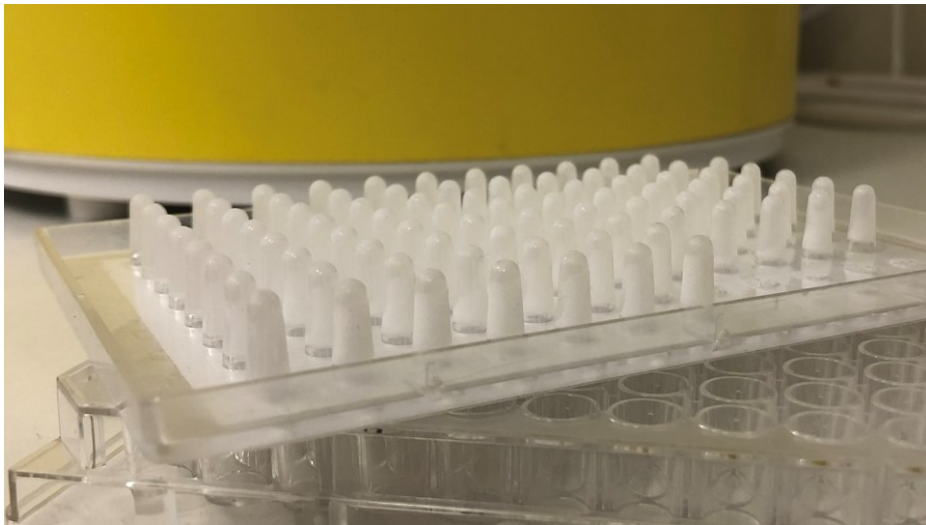
Obrázek 3 - Calgary biofilm device (z vlastní sbírky, nafoceno ve FNHK)
