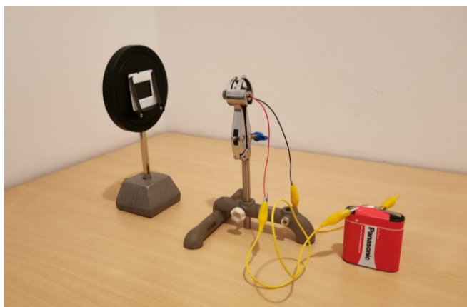
Obrázek 8-2: Nastavení aparatury pro Youngův experiment
