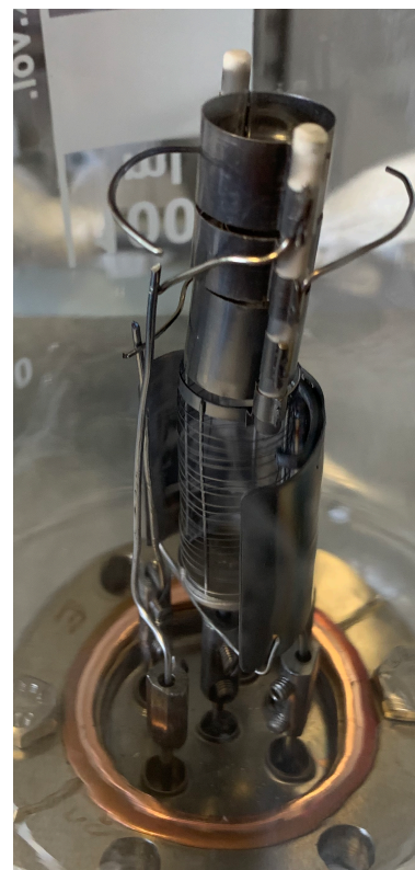
Obr. 12. Iónové delo použité v experimentoch
