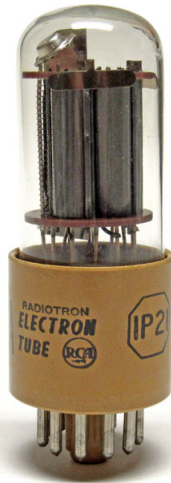
Obrázek 8.2: Fotonásobič RCA 1P21 [Obr. 25]
