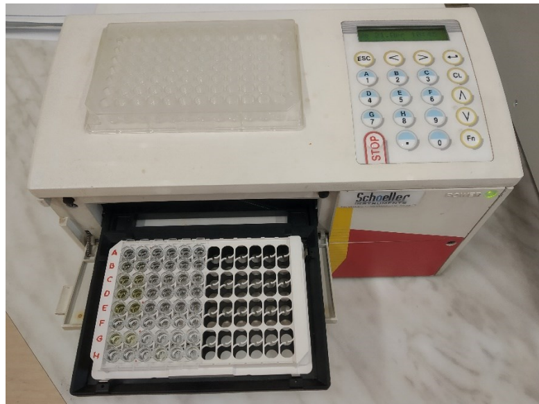
Obrázek 8: Spektrofotometr SLT Spectra
