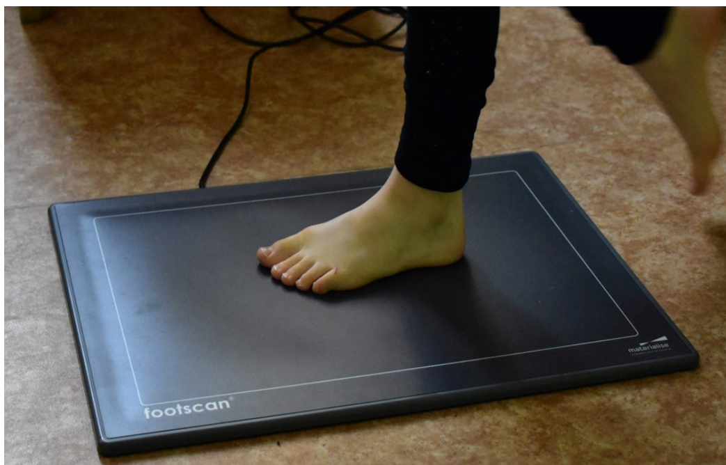
Obrázek 8 Měření pomocí tenzometrické desky na ZŠ Palachova (zdroj – vlastní)
