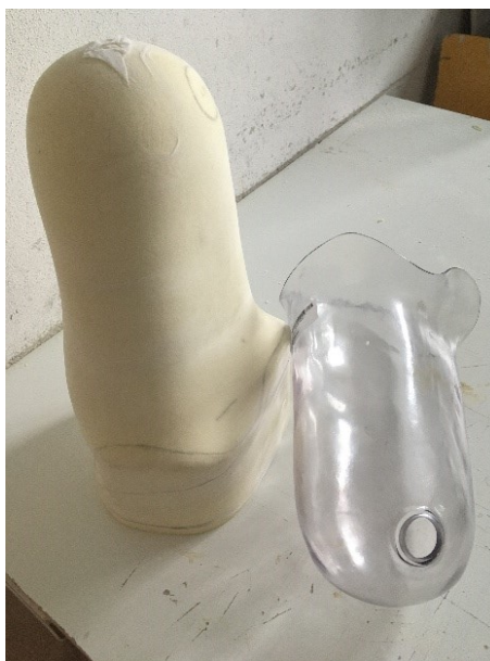
Obrázek 15: Vyfrézovaný model a diagnostické lůžko vytvořené metodou CAD/CAM (autorská fotografie)
