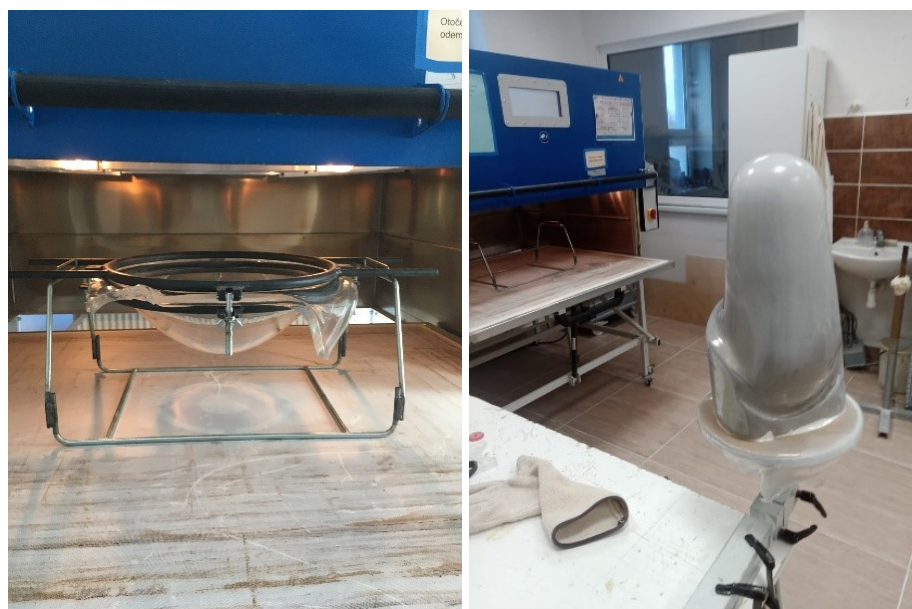
Obrázek 22: Výroba vnitřního měkkého lůžka ze Seaflexu (autorské fotografie)
