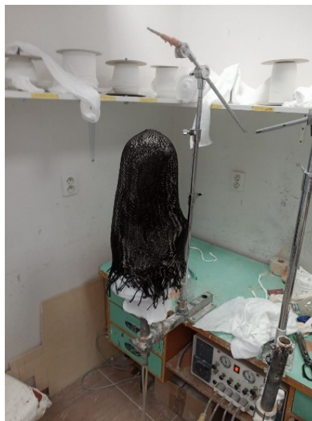
Obrázek 25: Ruční laminování – vnější karbonová vrstva (autorská fotografie)
