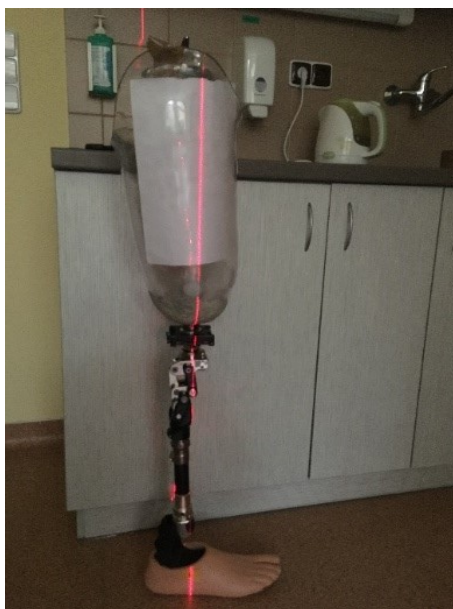
Obrázek 17: Hledání zátěžné osy laserovým měřidlem (autorská fotografie)
