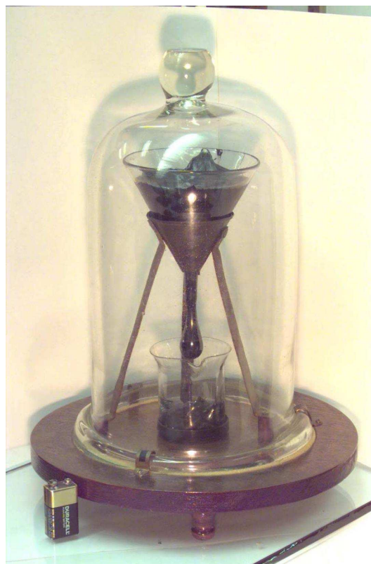
Obrázek 1.1: Experiment s kapajícím asfaltem
