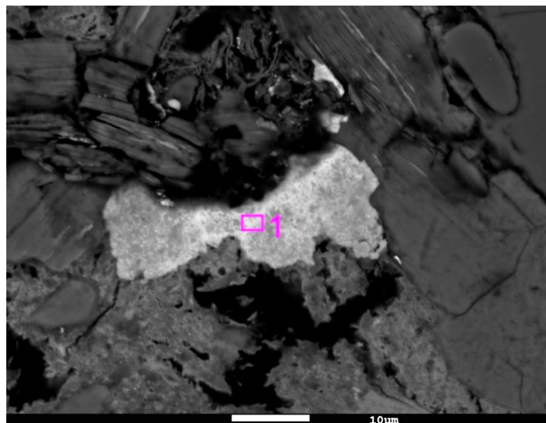
Obr. 46: Vzorek SM-5 pole 3 Detailní BSE snímek leukoxenu bohatého U, Th a Zr, (analýza Příloha 3d, SM-5_3/1).
