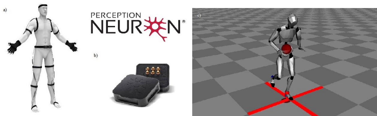
Obr. 2: a) Zařízení Perception Neuron při využití pohybových senzorů ve všech možných pozicích, b) „neuron“ inerciální měřící jednotka, c) rekonstrukce pohybu v programu Axis Neuron
