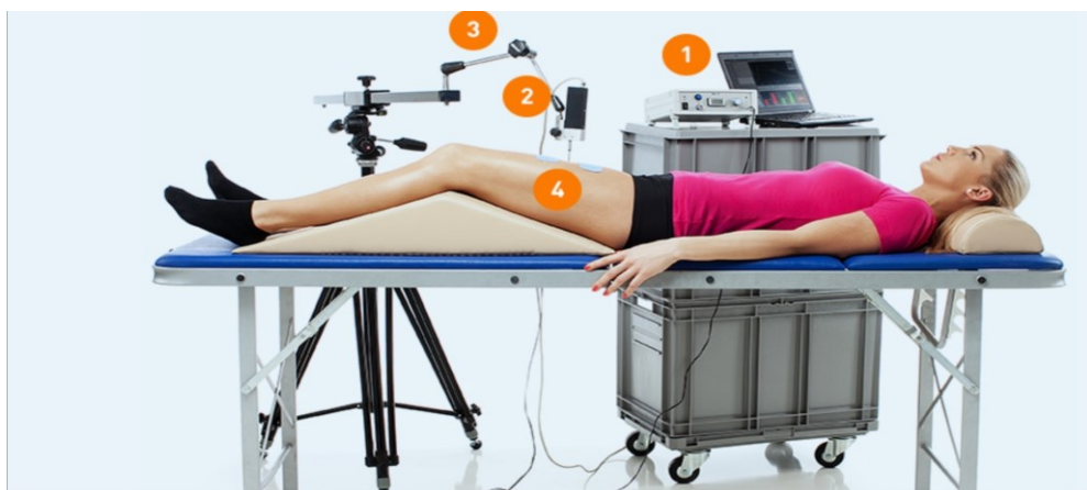
Obrázek č. 3 – Hlavní součásti přístroje TMG-100
