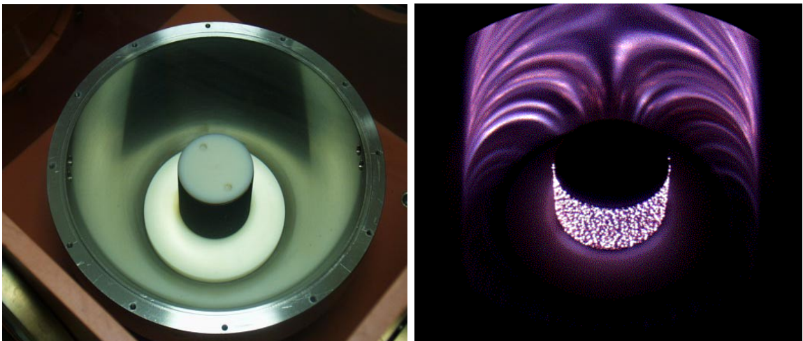
Obr. 9. experimentální generátor před výbojem (vlevo) v čase výboje (vpravo)
