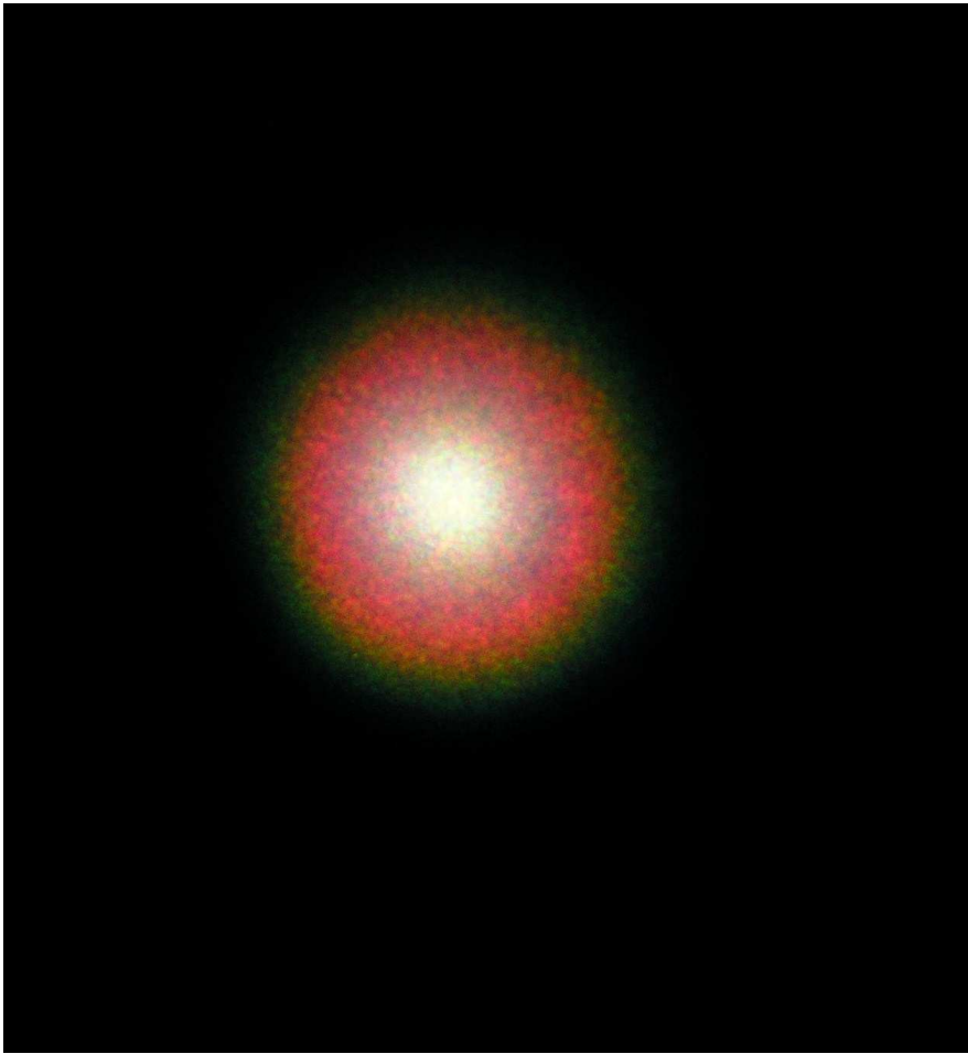
Obr. 13 – Kontinuum generované ve vzorku z křemenného skla, energie v pulsu 104 \mu\text{J} .
