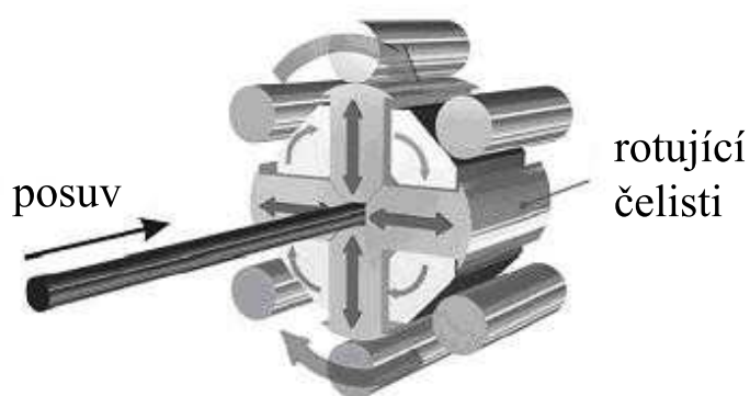
Obrázek 2.3: Schéma zařízení na kruhové kování
