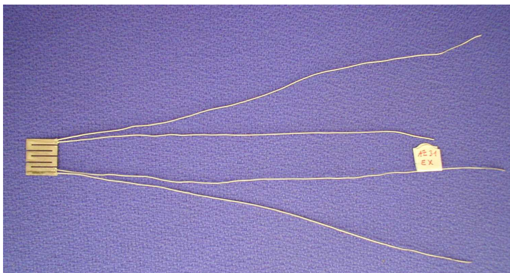
Obrázek 3.3: Vzorek EX připravený na měření rezistivity čtyřbodovou metodou
