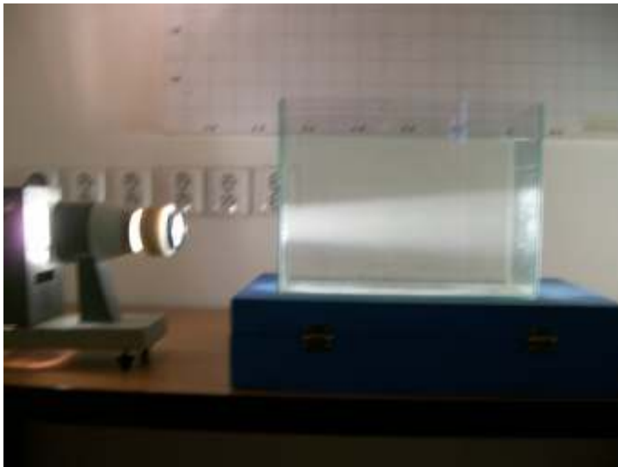
Obr. 4-1: Aparatura pro provedení Rayleighova rozptylu
