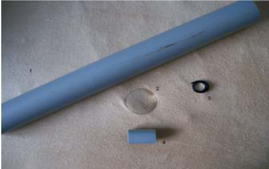
Obr. 1-2 Části dalekohledu: 1 )novodurová trubka, 2)objektivová čočka, 3) okulárová čočka, 4) krabička od kinofilmu
