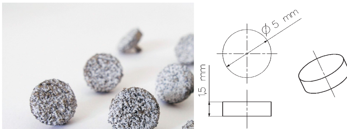
Obr. 6. Ukázka studovaných vzorků (vlevo) a jejich technický náčrt (vpravo).
