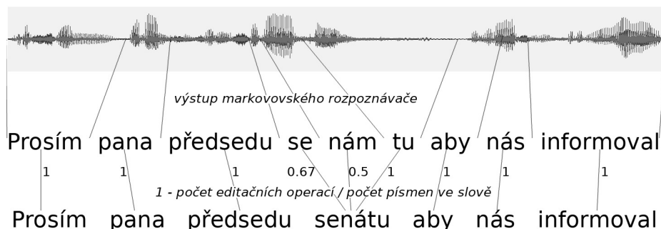
Obrázek 4.2: Schéma zarovnání zvukových záznamů ke stenografickým přepisům na úrovni slov.
