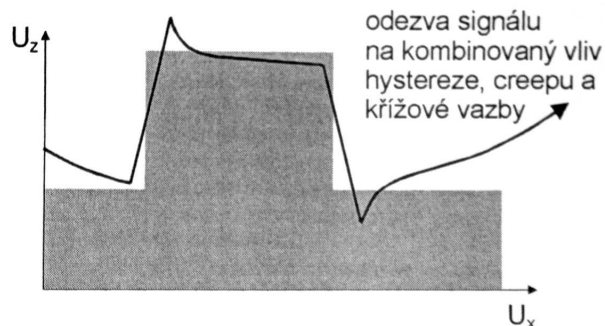
Obr. 15: Vliv hysterese, creepu a křížové vazby na zobrazení pravoúhlého schodu. Převzato z [1].
