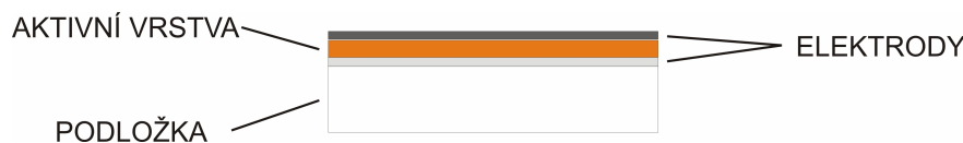
Obrázek 1.2: Jednovrstvý fotovoltaický článek
