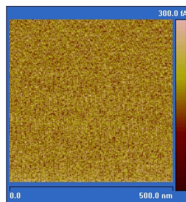
Lokální proud (přiložené napětí: 5V)
