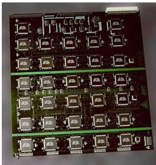
obr. 5 - několik čipů na jedné z desek stroje Deep Crack (zdroj: [28])
