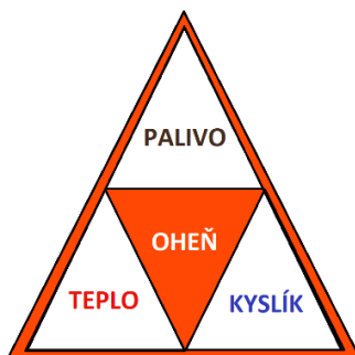
Obr. 1 - Trojúhelník ohně shrnující závislost hoření na palivu, tepelné energii a kyslíku
