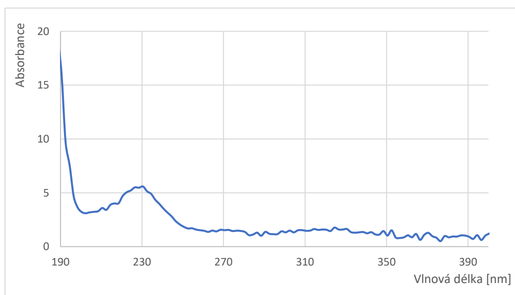
Obrzek 6: Optimalizace detekn vlnov dlky. Absorpn spektrum tetrachlorozlatitanu s absorpnm maximem 230 nm. Měřeno bhem analzy tetrachlorozlatitanu o koncentraci 5·10 -5 mol dm -3 s 20% podilem elektrolytu; použit křemenn kapilra o celkov dlce 80 cm (efektivn dlce 71,6 cm) a prměru 50 μm; dávkování vzorku tlakem 20 mbar po dobu 20 sec; vložené separan napět -20 kV; aplikovan tlak 20 mbar; základn elektrolyt o složení 0,01 mol dm -3 HCl a 0,04 mol dm -3 NaCl.
