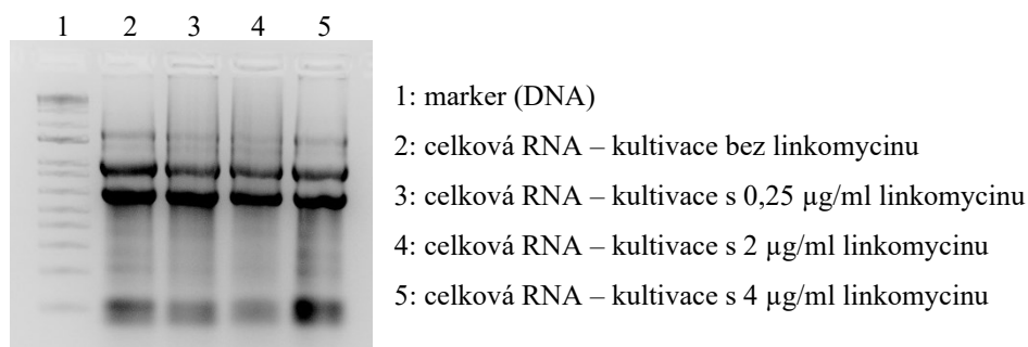
Obr. 24: Vyizolovaná celková RNA. RNA byla rozdělena RNA elektroforézou v 2% agarosovém gelu a vizualizována pomocí ethidium bromidu.
