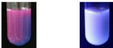
Obrázek 27 fluorescence fykocyaninu z tablety, vlevo pod stolní lampou, vpravo pod UV lampou
