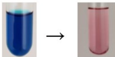
Obrázek 23 reakce tetrachloridokobaltnatého aniontu s destilovanou vodou
