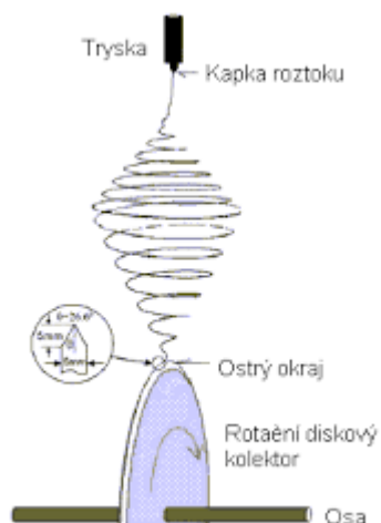
Obr. 10: Schéma principu elektrostatického zvlákňování – rotující diskový kolektor [9]
