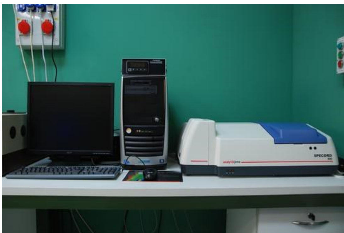
Obrázek 2.1.2. - Dvoupaprskový ultrafialovo-viditelný absorpční spektrometr Specord 250
