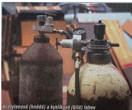
Obrázek 2 Acetylenová a kyslíková lahev, zdroj: Chemie II , s. 22, Prodos 2019.
