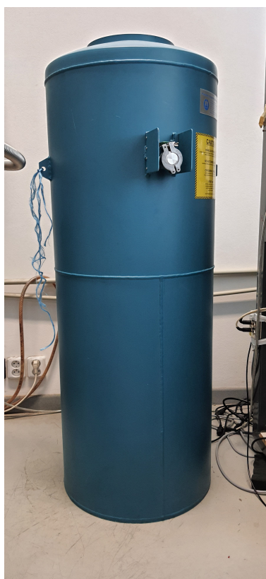
Obrázek 2.1: Kovový kryostat, s objemom hélíovej vane 60 l, použitý pri experimentoch.
