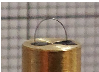
Obrázek 2.3: Mikrorezonátor v tvare približne polkruhovej slučky so vzdialenosťou nožičiek 3 mm.
