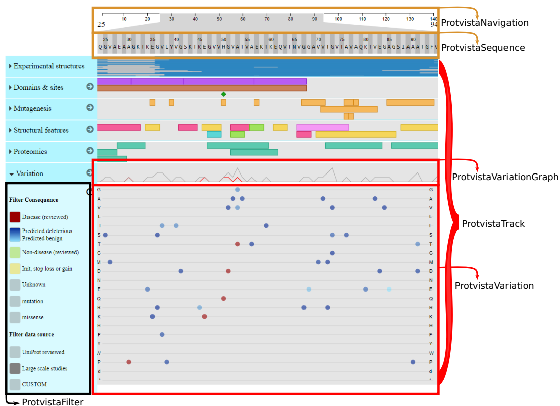
Obrázek 2.4: Ukázka Nightingale komponent. Všechny vyznačené komponenty jsou v DOM stromě prohlížeče potomci ProtvistaManagera.
