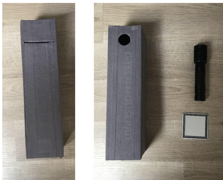
Obrázek 11 - Pomůcky pro rébus s "periskopem". Na levé fotografii je na krabičce zadní otvor pro umístění zrcátka. Na pravé fotografii je na krabičce otvor pro svícení a pozorování krabičky zevnitř pomocí zrcátka.
