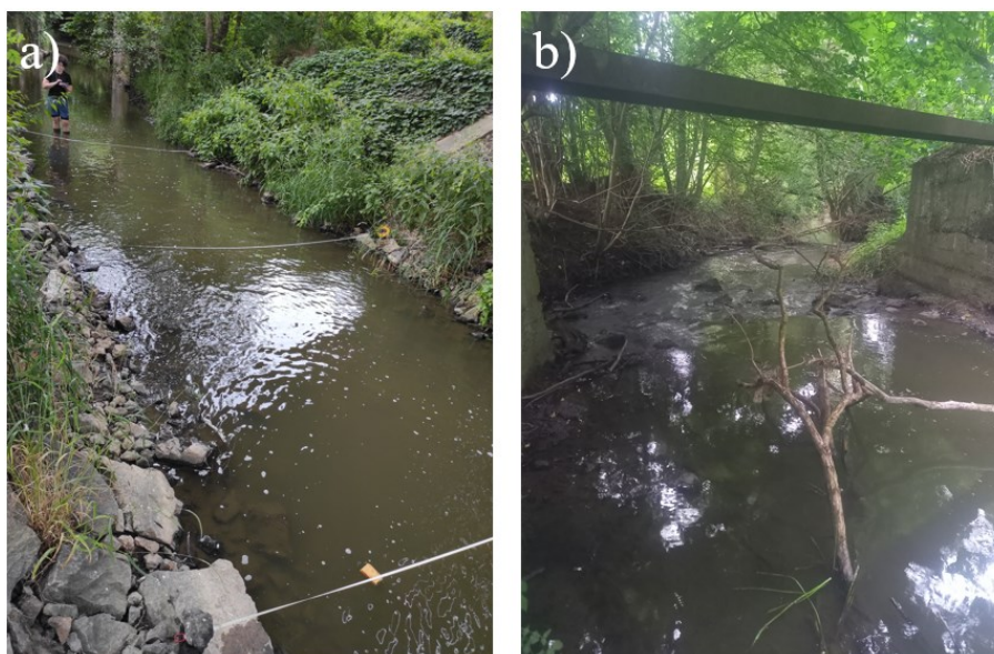
Obr. 16. Měření na Žehrovce 8.7.2021: a) měření plovákovou metodou na laminárním úseku toku (foto M. Slavík), b) úsek toku použitý pro měření chemickou metodou
