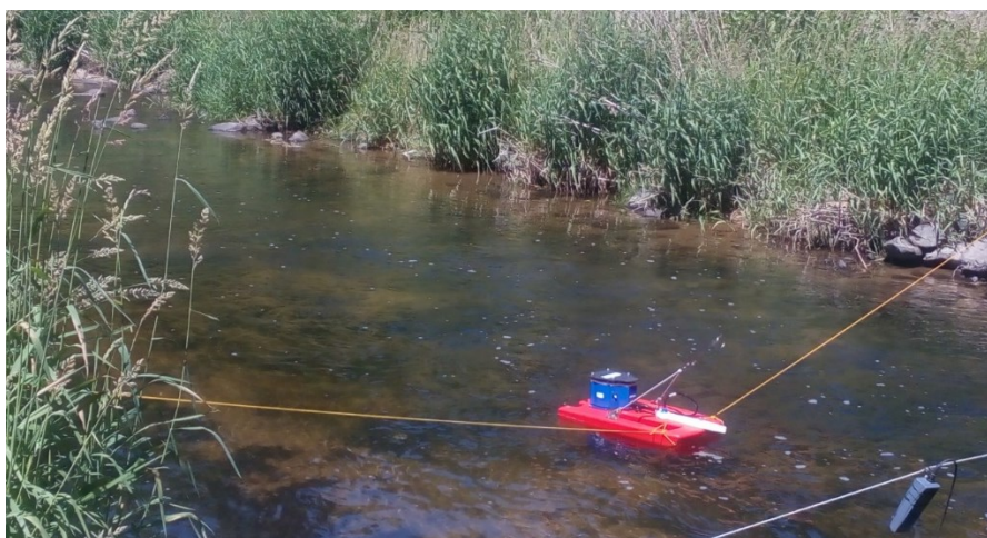
Obr. 9. Měření pomocí ADCP taženého na laně (foto: M. Slavík)
