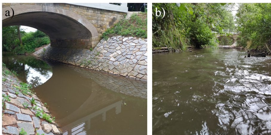
Obr. 17. Měření na Libuňce 8.7.2021: a) laminární úsek toku použitý pro měření vrtulí, FlowTrackerem a plovákem, b) turbulentní úsek toku, na kterém proběhlo měření chemickou metodou (foto M. Slavík)
