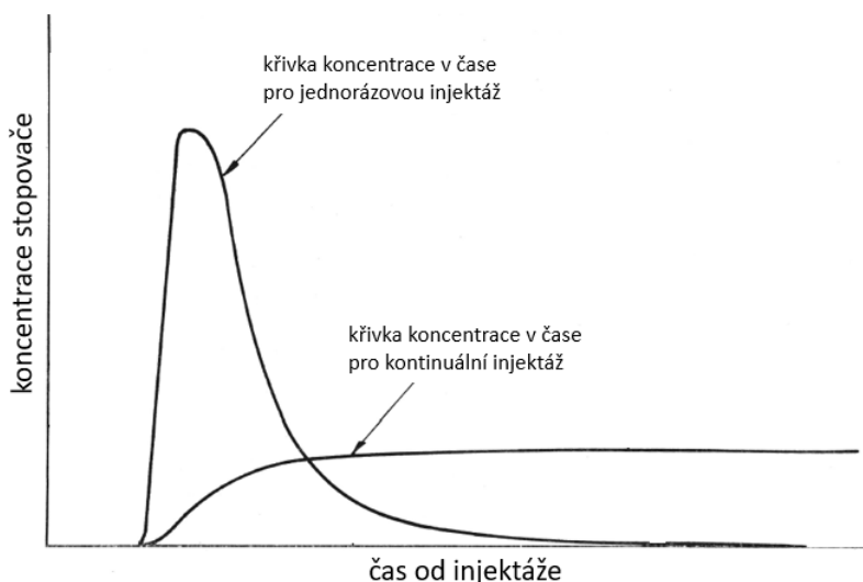
Obr. 10. Znáornění průběhu koncentrace stopovače v čase u jednorázové a kontinuální injekece (upraveno dle Bell, 1969)
