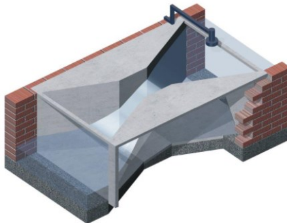
Obr. 12. Návrh konstrukce Parshallova žlabu (PARS aqua, 2021)
