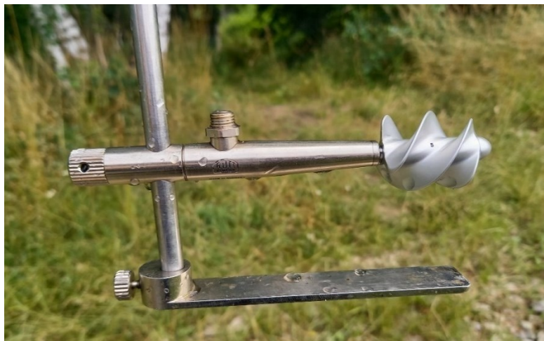
Obr. 1. Hydrometrická vrtule Ott C-2 na soutyčí s propelerem velikosti 5
