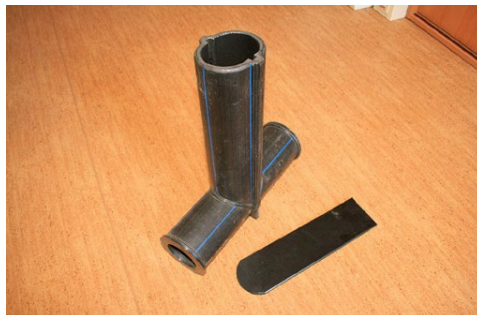
Obrázek 6: Ukázka regulačního prvku ve tvaru obráceného T Zdroj: Kulhavý a kol. (2020)
