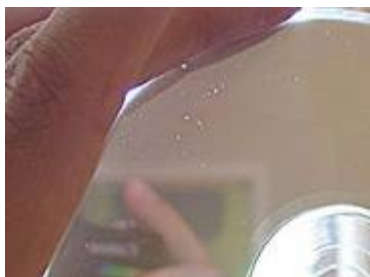
Obr. 40: Mizení metalizované vrstvy na CD (vadná konstrukce).
