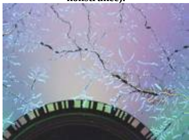
Obr. 43: Popraskání metalizované vrstvy z CD (nevhodné skladování).
