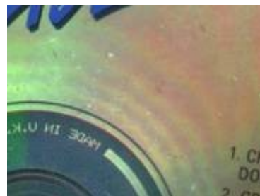
Obr. 45: Oxidace, změna barvy tzv. „bronzing“ (toxické obaly).
