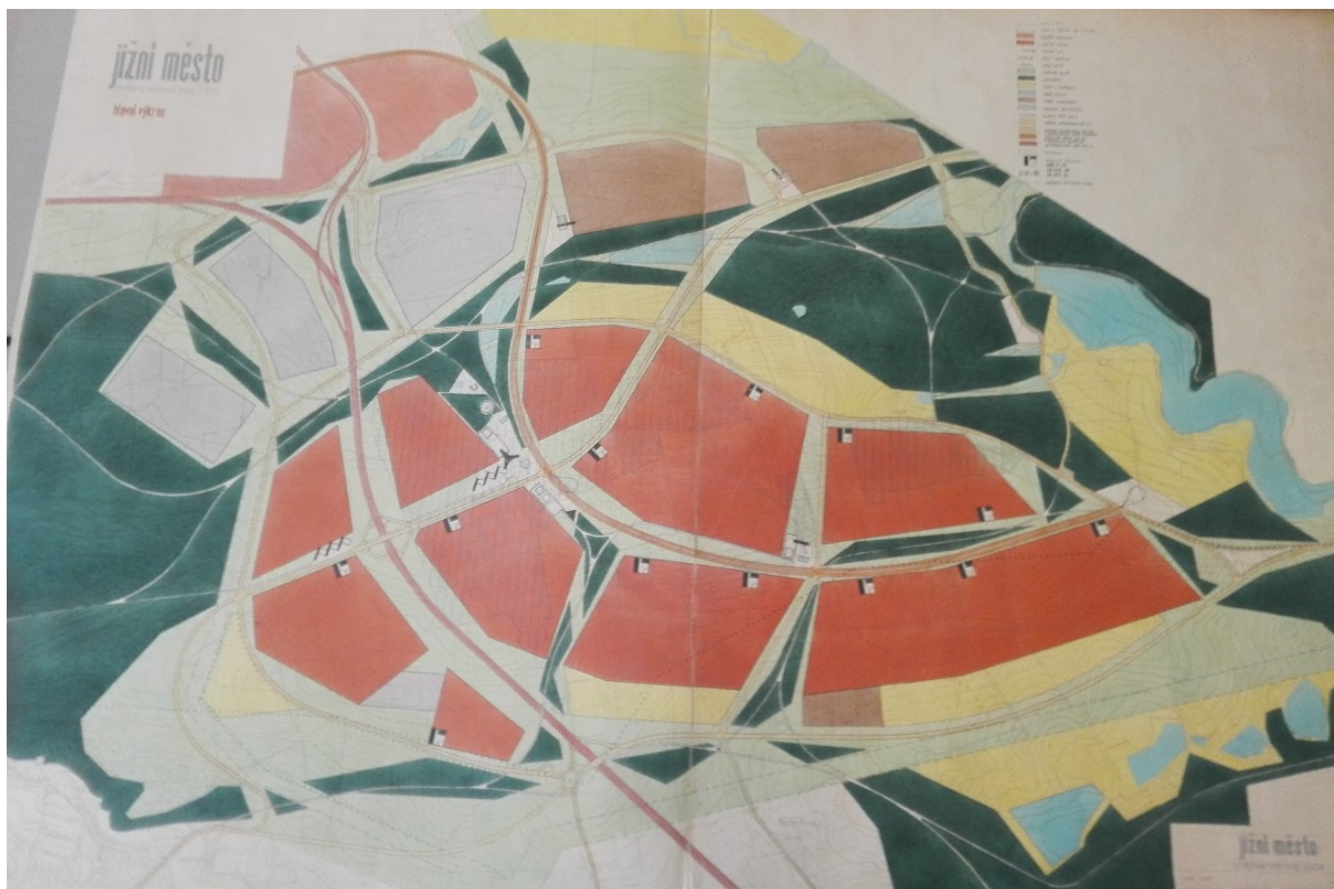
Obrázek 1 – Výsledná prověřovací studie - hlavní výkres, rok 1964. Červeně jsou vyznačeny plochy určené pro obytné soubory, světlešedě průmysl a pracovní příležitosti, hnědě vyšší vybavenost, žlutě rekreační a sportovní území, zeleně zalesnění a modře vodní plochy. Červená čára značí budoucí dálnici, oranžová plánovanou tramvajovou trať, černobílé čtverečky okrsková centra. Zdroj: archiv IPR HMP
