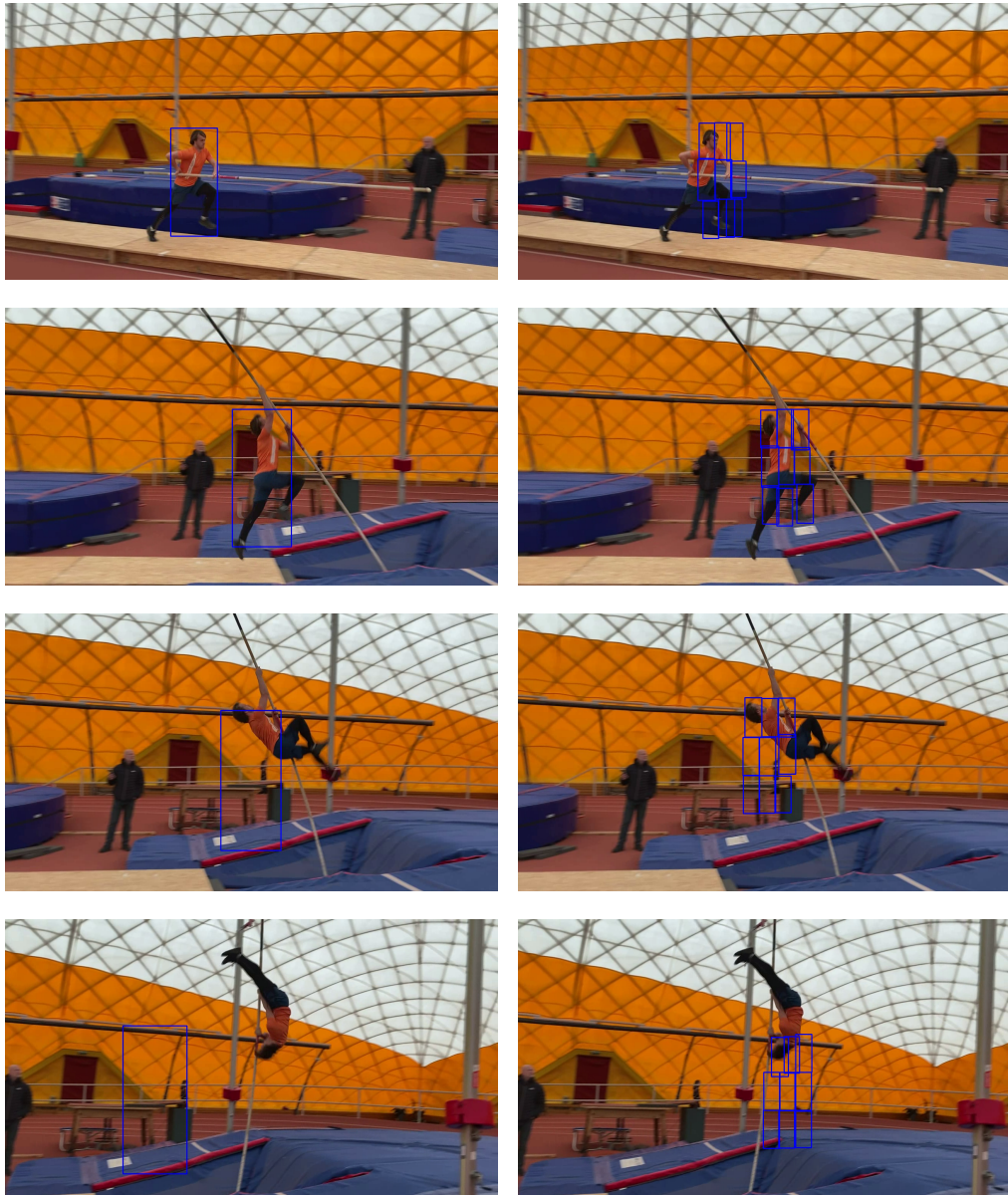
Obrázek 2.4: Použití jednoho trackeru (vlevo) a mřížky trackerů, která je implementovaná v programu (vpravo).
