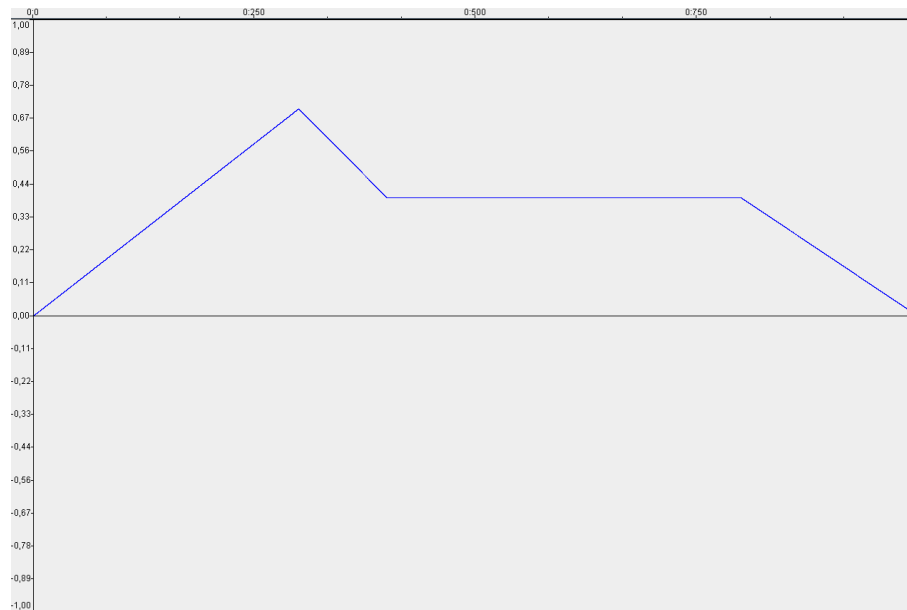
Obrázek 4.36: Envelope (obálka) s lineárními přechody mezi fázemi a následujícími parametry: Attack time = 0.3, Attack amplitude = 0.7, Decay time = 0.1, Sustain time = 0.4, Sustain amplitude = 0.4 a Release time = 0.2
