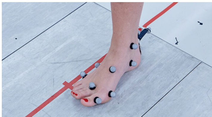
Obrázek č. 4 Ukázka senzorů Vicon (Vicon, [b.r.])
