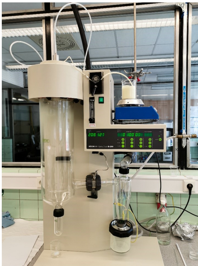
Obrázek 3: Sprejová sušárna Büchi Mini Spray Dryer B-290
