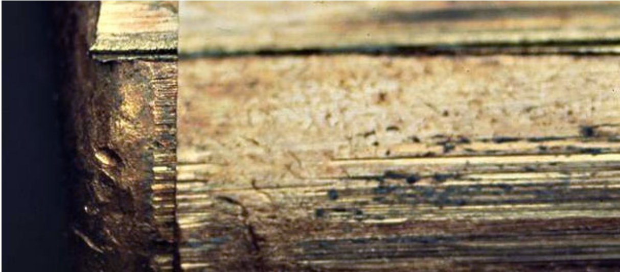
Srovnání dvou střel, vlevo nalezená na místě činu a vpravo testovací, Zdroj: Forensic Science Simplified [online]. [cit. 16.12. 2020], Dostupné z: http://www.forensicsciencesimplified.org/firearms/principles.html
