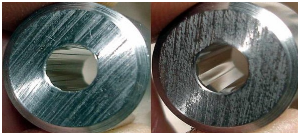
Běžný vývrt - šroubovice (vlevo) a polygonální vývrt (vpravo), Zdroj: Airgun Accuracy [online]. [cit. 15.12.2020], Dostupné z: https://airgunaccuracy.wordpress.com/polygonal-and-rifled-barrels-compared-for-bc-and-velocity/
