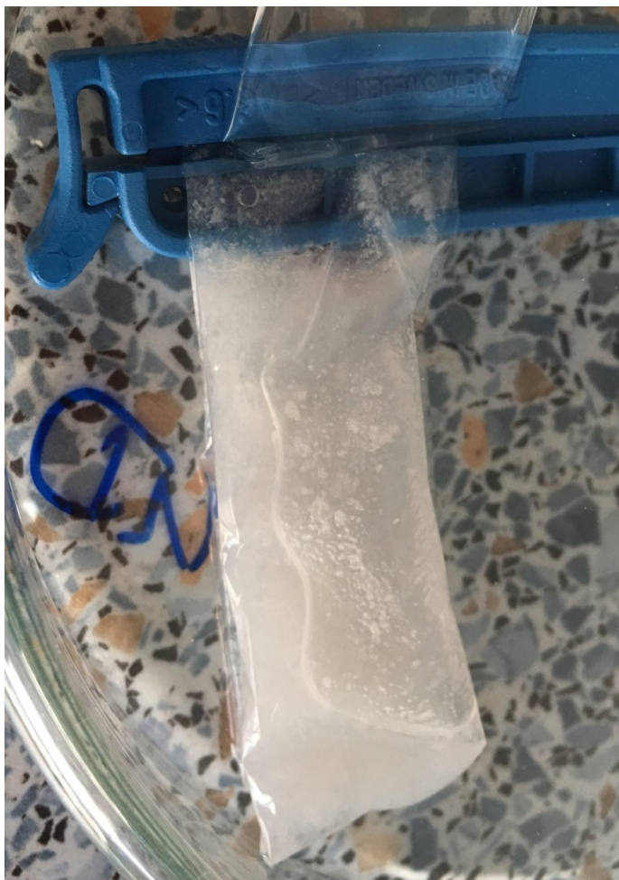
Obrázek 9 - Vysrážení LN v dialyzační membráně
