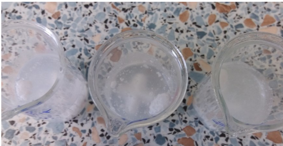
Obrázek 19 - Použitý surfaktant Kolliphor P188 – na hladině jsou shluky lipidů
