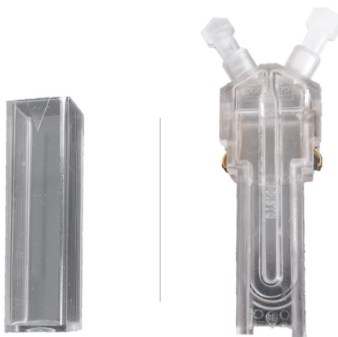
Obrázek 19 Jednorázová polystyrenová kyveta DTS 0012 pro měření distribuce velikosti částic metodou DLS – vlevo. Polykarbonátová kyveta DTS1060 pro měření ZP metodou LDE – vpravo.
