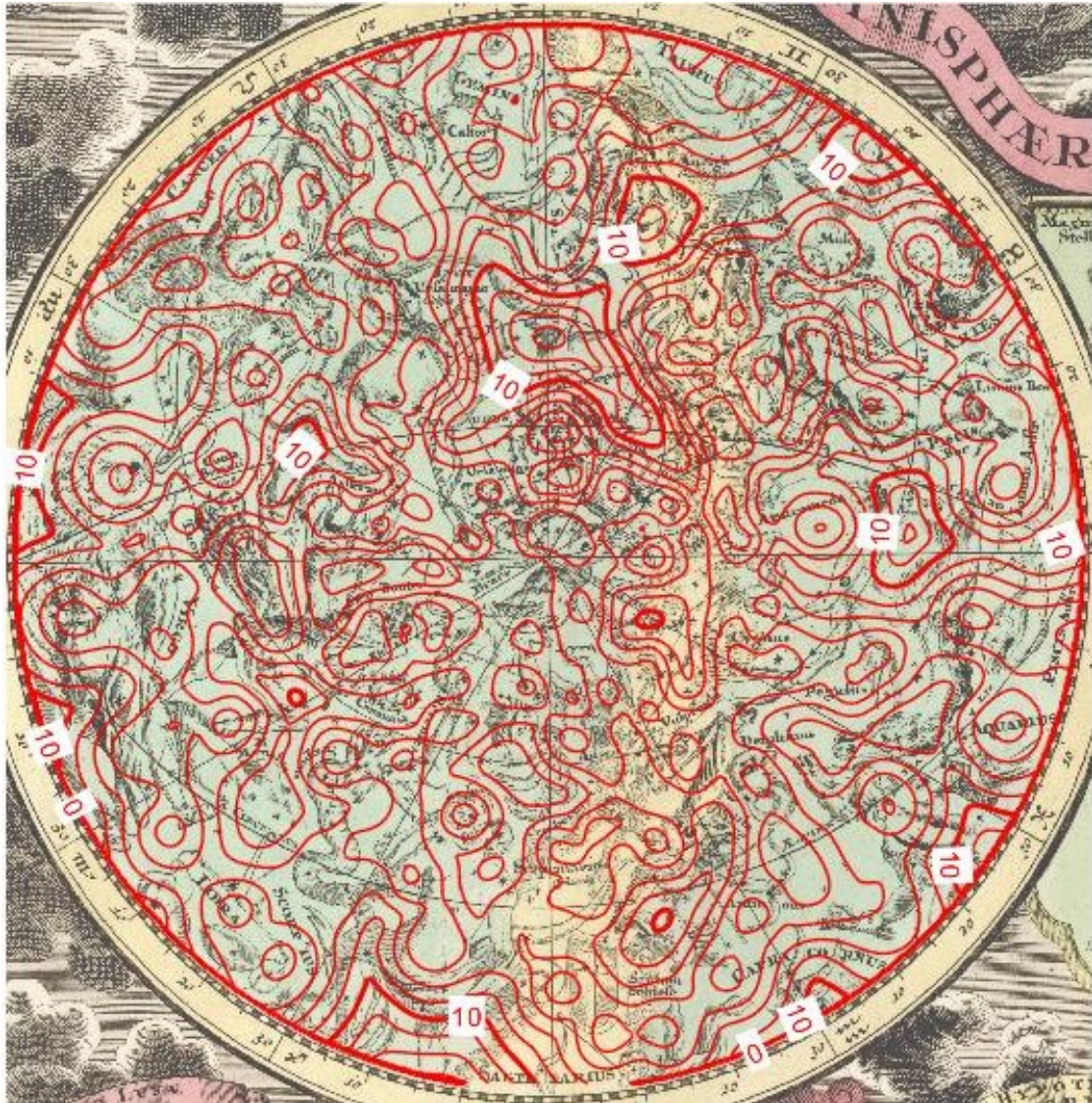
Obr. 74: Izolínie presnosti zákresu (bez započítania vplyvu precesie) na severnej hemisfére mapy PLANISPHAERIUM COELESTE, zdroj: Vlastný (2019)
