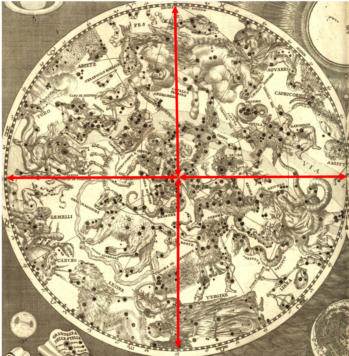
Obr. 38: Merané vzdialenosti k okrajovým bodom mapového poľa, od stredu mapy, použité na výpočet polomeru sféry, zdroj: Vlastný (2020)
