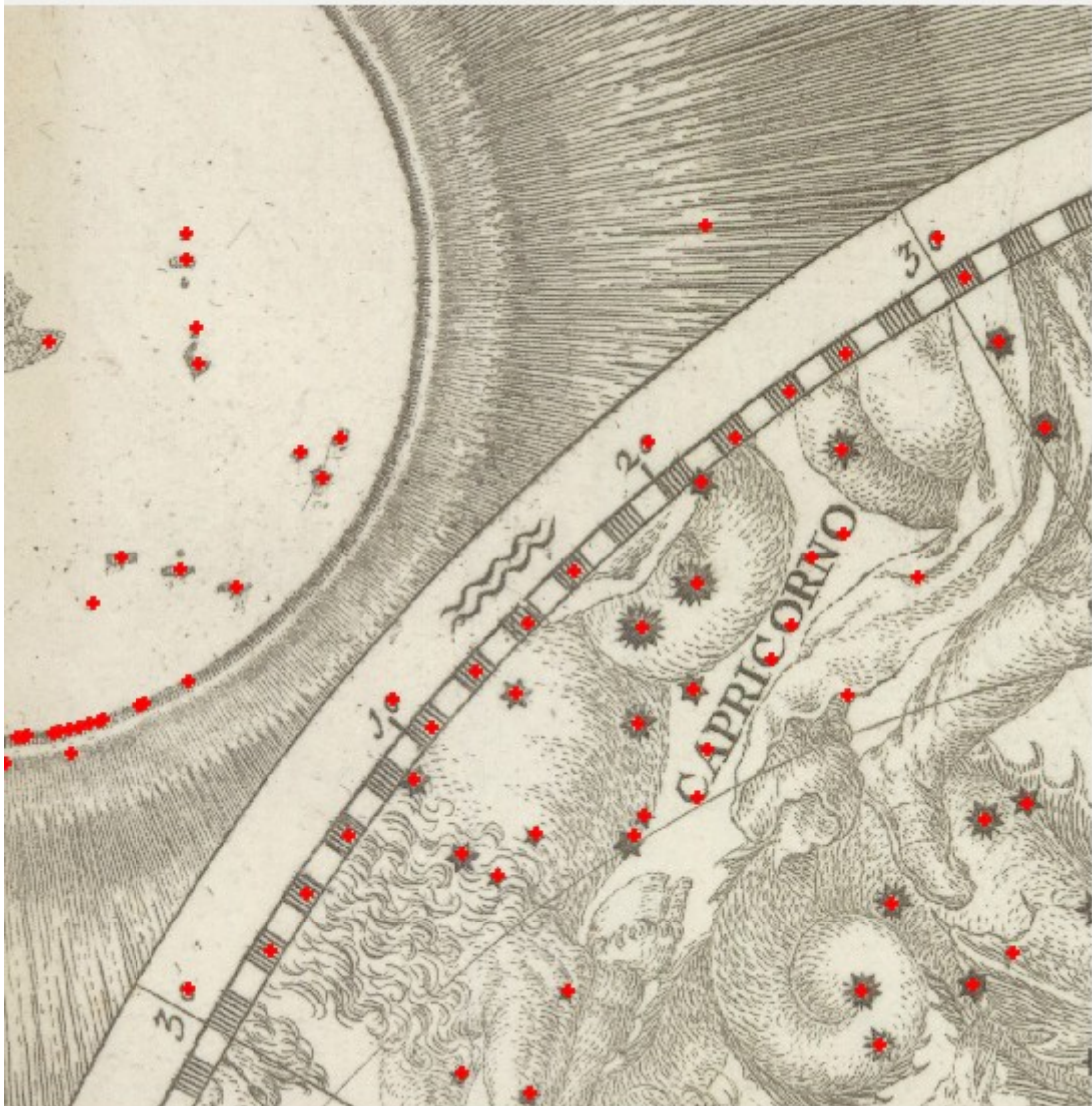
Obr. 47: Ukážka chybne identifikovaných objektov (okraj mapového poľa, kartuš, písmo, číslice) na mape Planisfero del globo celeste, zdroj: Vlastný (2019)
