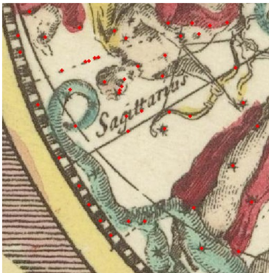
Obr. 58: Ukážka chybne identifikovaných objektov (okraj mapového poľa, kartuš, písmo, číslice) na mape Planiglobium coeleste, zdroj: Vlastný (2019)
