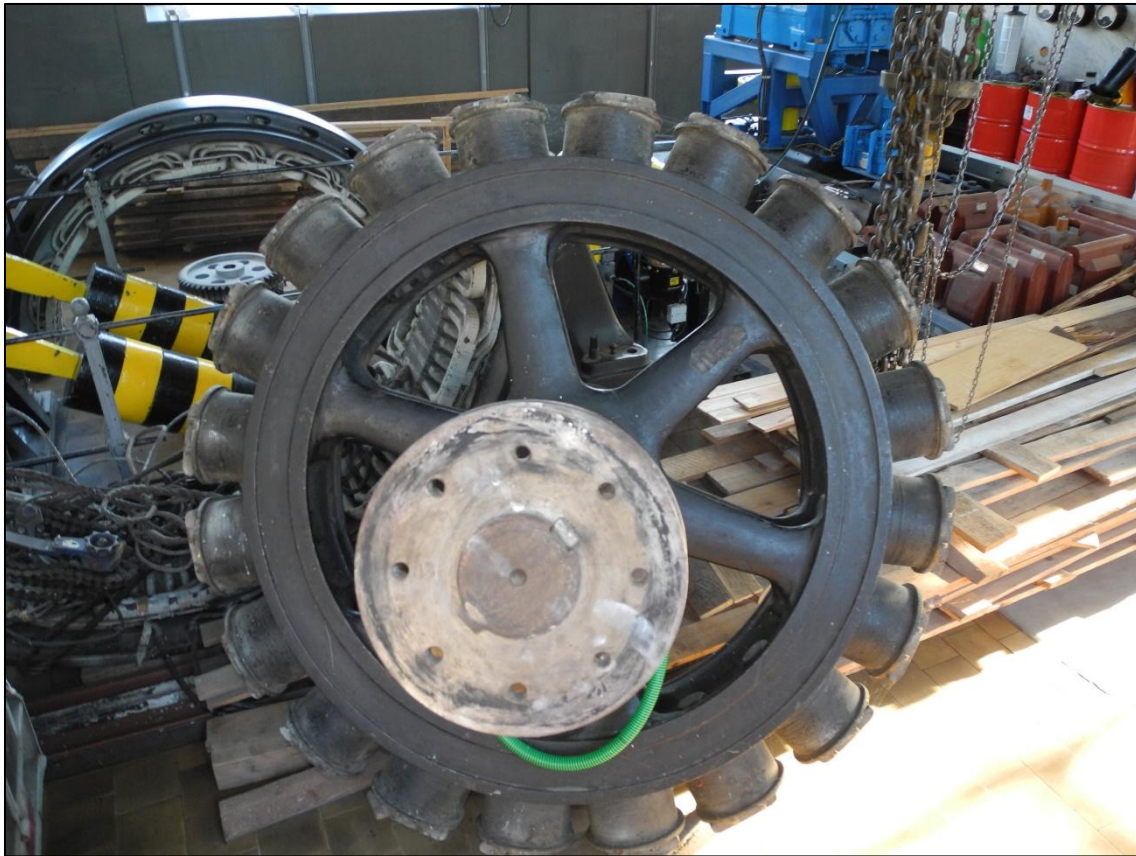
Obrázek 93. Pohled na demontovaný rotor generátoru II. Foto Jiří Chmelenský, 2015.
