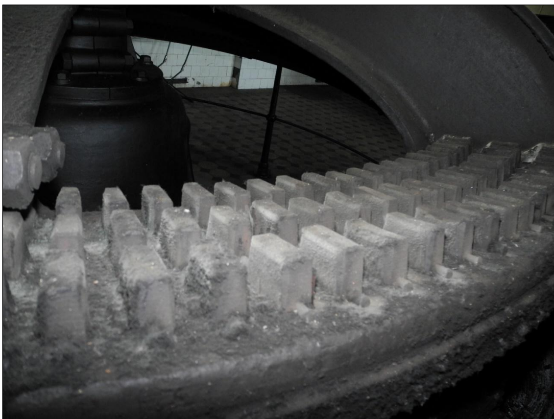
Obrázek 169. Detail zubů osazených ve zvonovém kole I. Foto Jiří Chmelenský, 2015.
