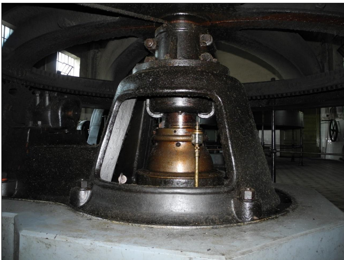
Obrázek 167. Detail ložiska vertikální hřídele turbíny a zvonového kola, vlevo je patrný horizontální převod. Foto Jiří Chmelenský, 2015.
