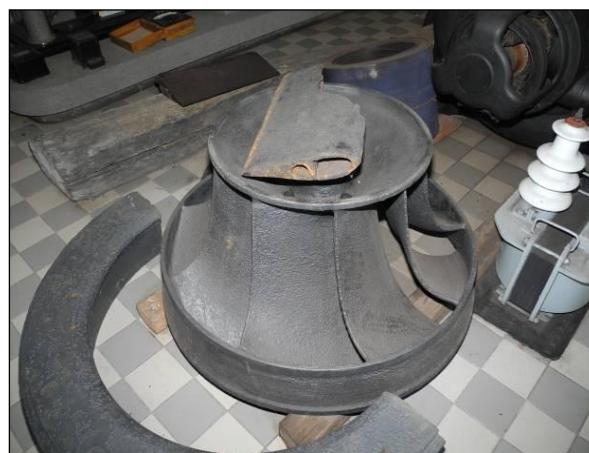
Obrázek 39. Francisova vertikální turbína ukrytá pod uzavřenými regulačními lopatkami. Nahoře je patrná hřídel turbíny, vodící ložisko, pak víko turbíny (štít) s manipulačními háky, dále uzavřené regulační lopatky a regulační kruh. MVE Bakov nad Jizerou (okr. Mladá Boleslav). Foto Jiří Chmelenský, 2015.
