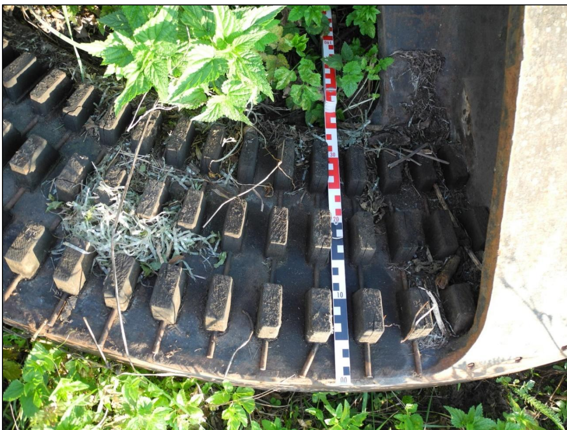
Obrázek 98. Detail dřevěných palců setrvačnicku. Foto Jiří Chmelenský, 2015.
