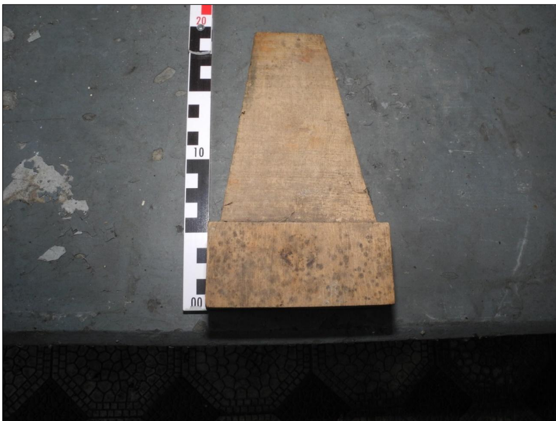
Obrázek 168. Polotovár záložního habrového zubu do zvonového kola. Foto Jiří Chmelenský, 2015.
