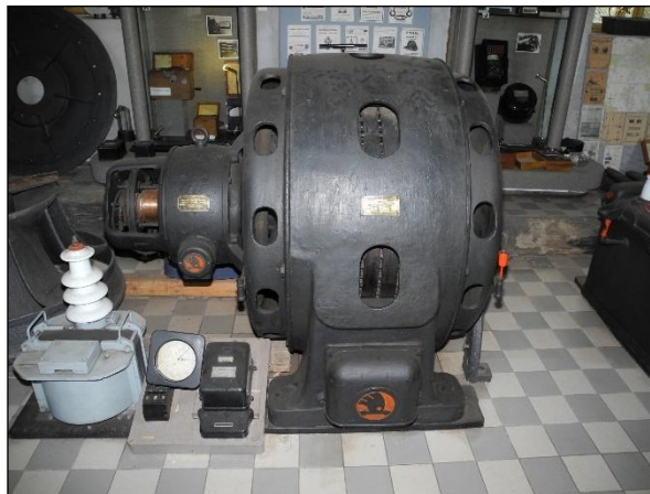
Obrázek 51. Stejnoseměrné dynamo od Františka Křížika. Konstrukce z roku 1886, kdy toto dynamo sloužilo k osvětlování města Písku a bylo poháněno lokomobílu. MVE města Písek, okr. Písek. Foto Jiří Chmelenský, 2015.
